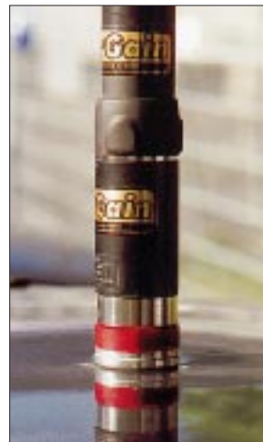
OE3JKS nutzte für seine brauchbare Selbstbau-Befestigung den vollen Fußdurchmesser des ATAS-100 und ein zwischen Himmel und Dach des Pkw eingebautes Verstärkungsblech. Fotos: OK1VHF (2), DJ1TO (2)
