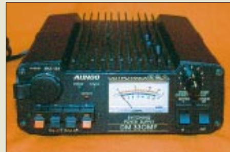
Alincos auffallend kleines Schaltnetzteil gestattet die Variation der Taktfrequenz zur Elimination von Empfangsstörungen.
